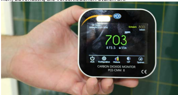
Alles im grünen Bereich: Die CO 2 -Ampel zeigt einen Wert unter 800 ppm. Dann ist die Luft noch in Ordnung. Foto: Stadt Eppelheim
